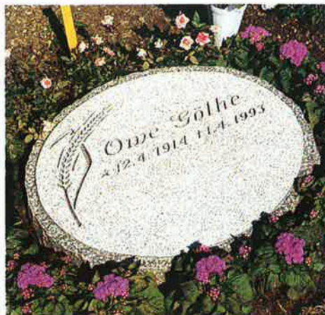
F35-822 Mörkgrå GS granit. Ovansidan finhuggen, kanterna råtillsatta, kantslaget spetsmejslat, djupblästrad dekor och text.
