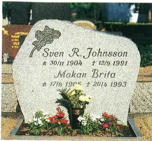
F1-969 Mörkgrå GS granit. Framsidan finhuggen, kanterna råtillsatta, dekoren skulpturblästrad.
